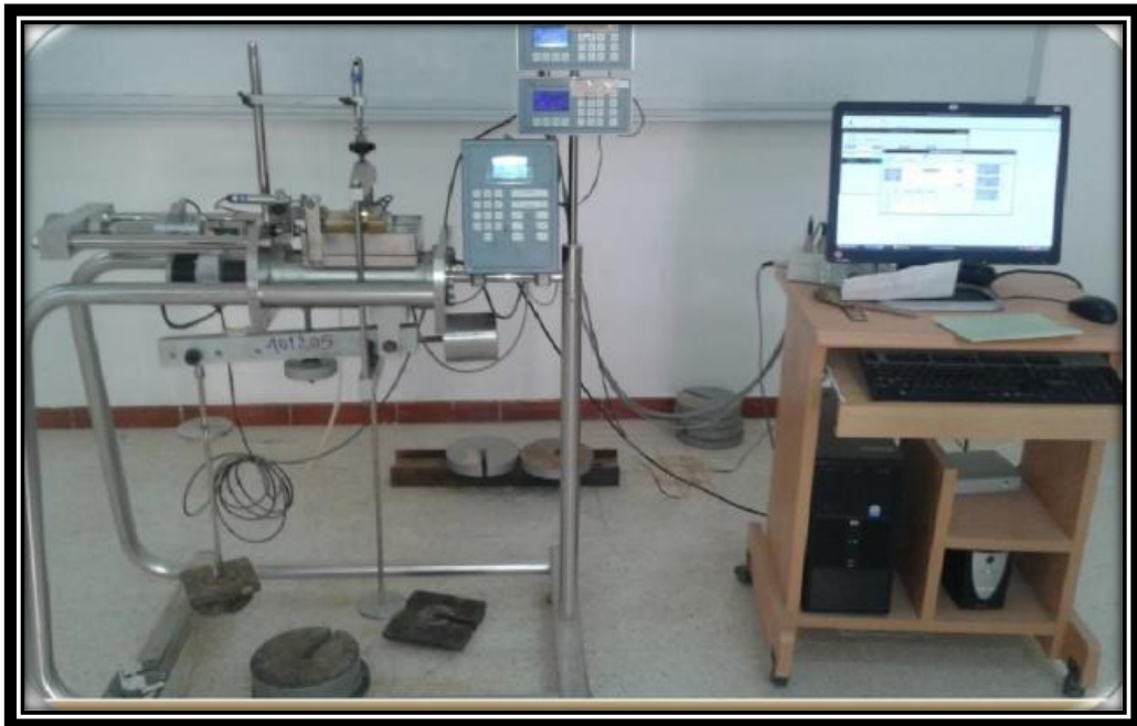
Figure 72 : Appareil de cisaillement rectiligne ou à la boîte de cassagnarde.
